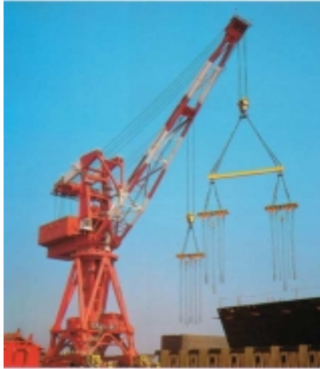
旧型塔型水平引き込みクレーン
