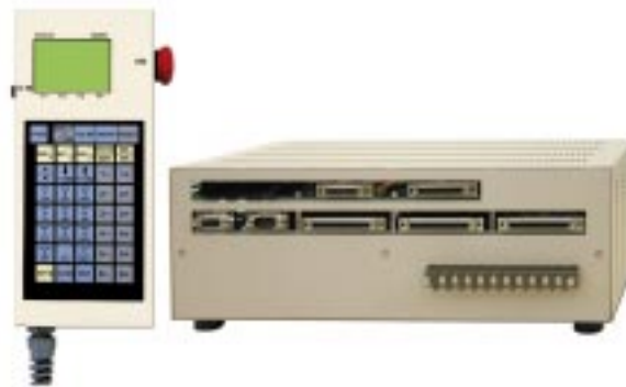
図3 モーションコントローラ MP-Pulse Motion controller MP-Pulse
