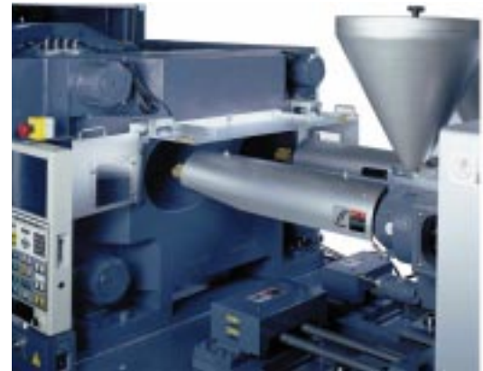
図5 射出装置 Injection unit
