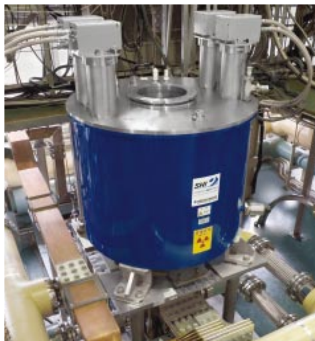
図1 ハイブリッドマグネット用ヘリウムフリー超電導マグネット Cryocooler-cooled superconducting magnet for hybrid magnet
