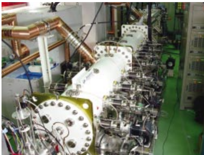
重粒子線がん治療装置用小型入射器 Compact injector of heavy-ion cancer therapy system
