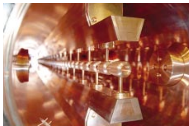
図5 DTL内部 Internal view of DTL
