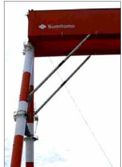
図4 揺脚上部 Upper part of hinged leg
