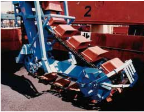
図2 石炭掻取り部 Toe of bucket elevators
