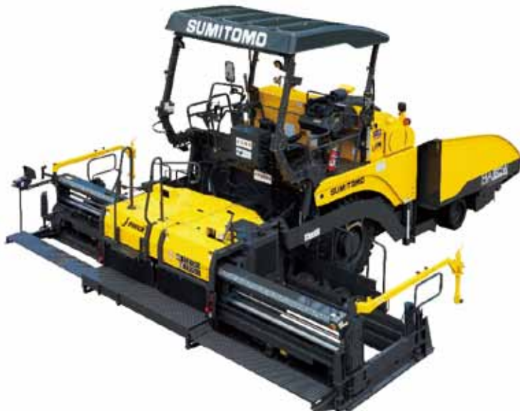
図1 ホイール式アスファルトフィニッシャー HA60W-10 Wheeled paver HA60W-10
