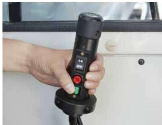
図11 ECOモードスイッチ ECO mode switch
