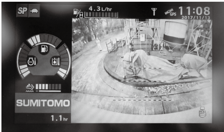
図10 人ではないが人らしいと判定した例 Example of recognizing background as human by mistake
