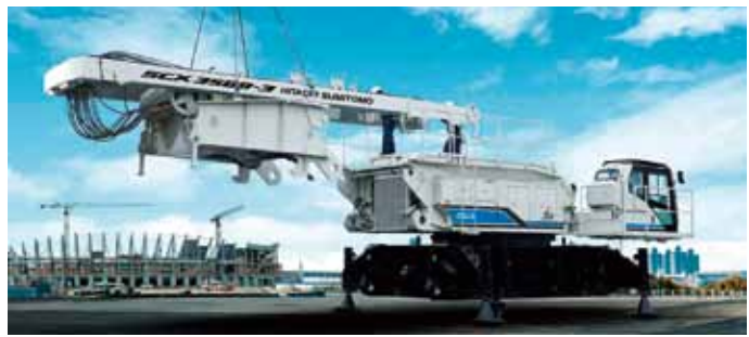
図3 前後分割型メインフレーム Front-rear split frame
