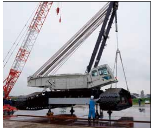
図5 クイックドローによる組立て Assembly by quick draw system
