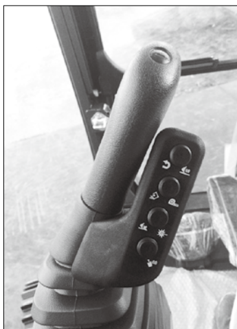
図4 2 DMGレバースイッチ 2 DMG lever switch
