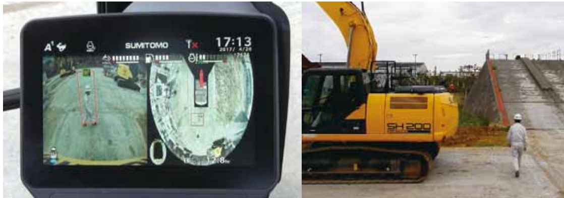
油圧ショベルのフィールドビューモニター2 Field View Monitor 2 on hydraulic excavator
