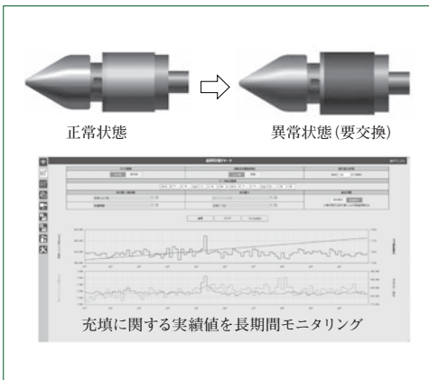
図7 スクリュー部品のメンテナンス時期判断 Judgment of maintenance timing for screw parts
