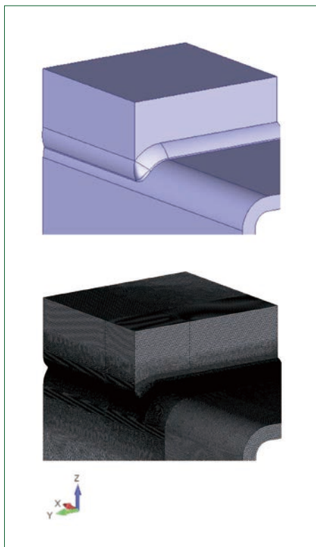
図3 回し溶接部の形状とメッシュ分割図 Shape of boxing and mesh division diagram
