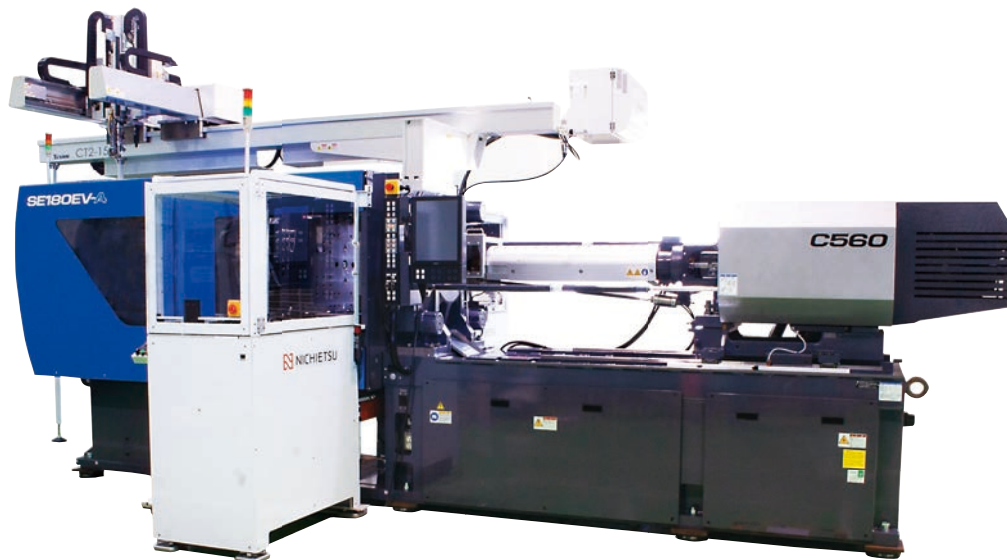
高速自動金型交換システム外観 External view of automatic quick mold change system
