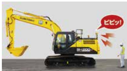
図4 周囲アラーム Alarm to surrounding construction machinery
