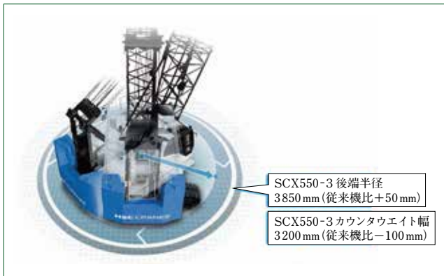
図1 機械幅と後端半径 Width and rear end swing radius
