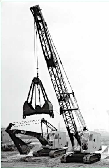
図2 ロープ式万能掘削機 (LS-78) Rope type universal excavator (LS-78)
