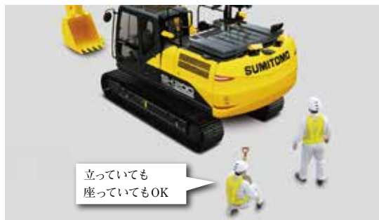
図2 人検知機能 Human detection function
